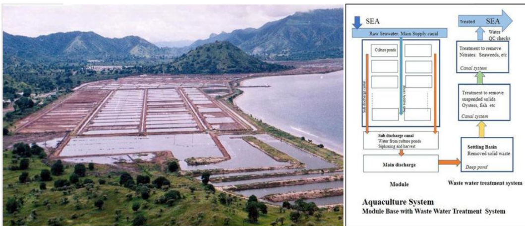
شکل (۲) حوضچه مجزا با سیستم تصفیه پساب [۷].
