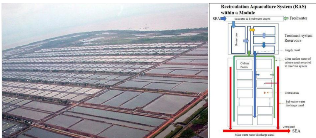
شکل (۳) سیستم آبی پروری بازچرخشی [۹].
