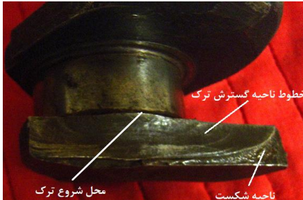
شکل (۱۱) شکست خستگی در میل لنگ VW
