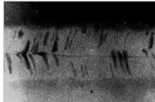
شکل (۵) ترک زیر جوش در فلز پایه
