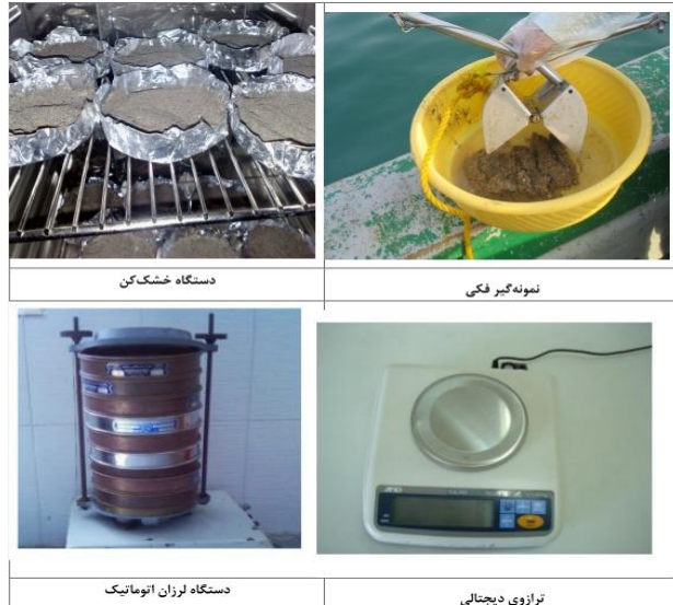
شکل (۲): وسایل مورد نیاز برای دانه بندی رسوب
